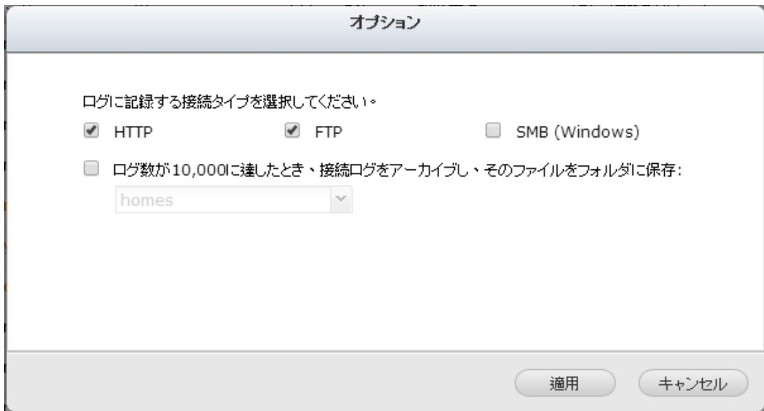
このページ上で、ファイルレベルのアクセスログが利用可能です。 VioStor は、ユーザーがアクセスした履歴、状況（ファイルまたはフォルダにアクセス、作成、削除、移動、または、名称変更等）をログとして残します。
