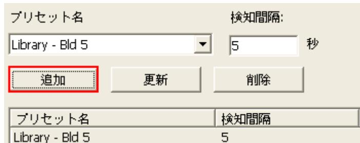
6. 更新：一覧の設定を変更するには、一覧から選択を行い、ドロップダウンメニューから別のプリセットを選択して待機時間（検知間隔）を変更します。その後「更新」をクリックしてください。
