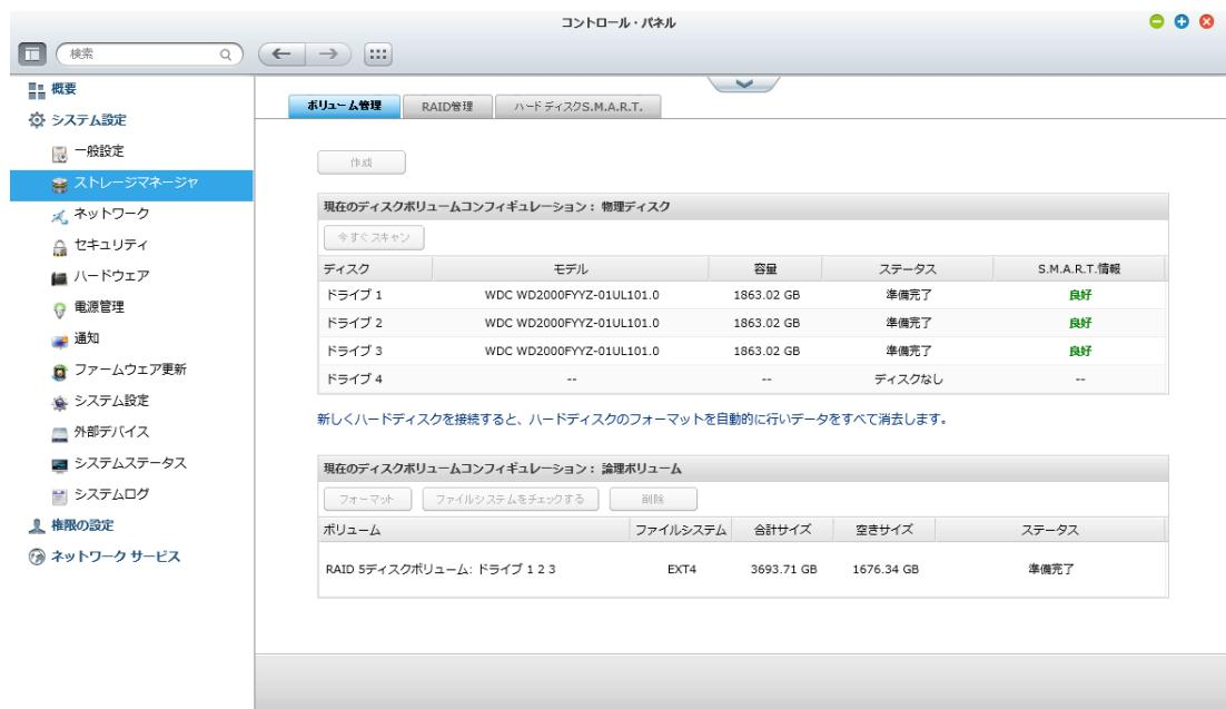
ハードディスク S.M.A.R.T を確認する場合は、ハードディスク S.M.A.R.T.→のタブをクリックし、S.M.A.R.T. 情報にて内容の確認ができます。
