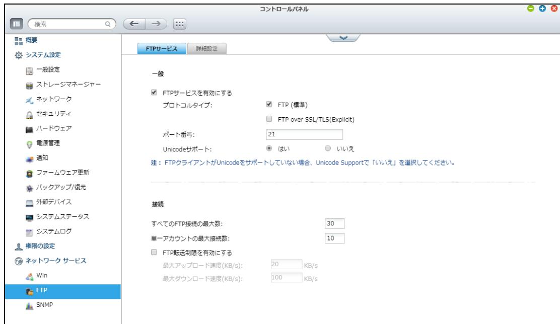
FTP サービスを使用するには、この機能を有効にします。IE ブラウザを開いて、アドレス欄に「ftp://”VioStor IP”」と入力して VioStor に接続できます。 ユーザー名およびパスワードを入力し、FTP サービスにログインします。
