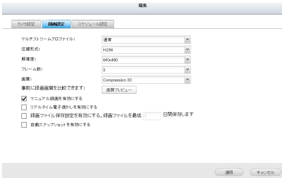
6. ビデオ圧縮、解像度、フレーム数および画質を設定します。また、追加で音声録音、マニュアル録画、録画ファイルの保存設定、ウォーターマーク、および自動スナップショットの設定を有効にするには、必要な項目にチェックを入れてください。「マルチストリームプロファイル」が使用できるカメラについては、次項を参照してください。
