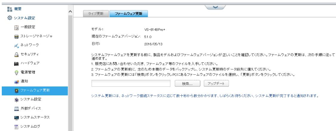
システムのファームウェアを更新する前に、製品モデルとファームウェアバージョンが正しいことを確認してください。以下の手順に従い、ファームウェアを更新します（※ファームウェアの更新中は、VioStor の電源を落とさないでください）。
