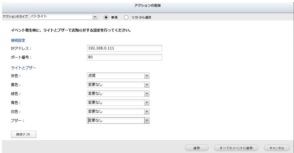
ネットワークパトライトのIPアドレス、ポートを入力し、そのイベントに対応した動作として、赤色・黄色・緑色・青色・白色の点滅/点灯/点灯パターン1/点灯パターン2及び、ブザーのパターン1～4を選択して設定を行っていただくことにより、イベントが発生した場合、パトライトによる通知が可能です（通知のOFFは機器本体にて手動で行ってください）。
