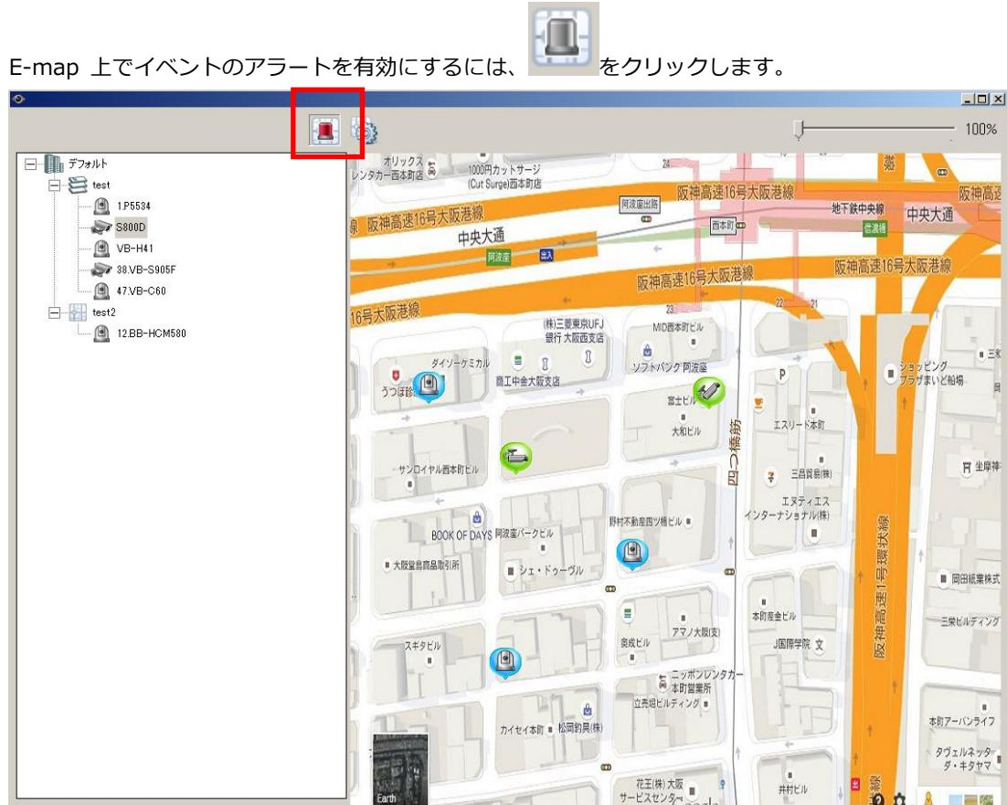
E-map 上のカメラにイベントが発生すると、カメラアイコンがフラッシュして通知します。イベントが発生したカメラは、アイコン上にイベントアイコンが表示されます。アイコンをクリックすると設定した指定動作を行います。
