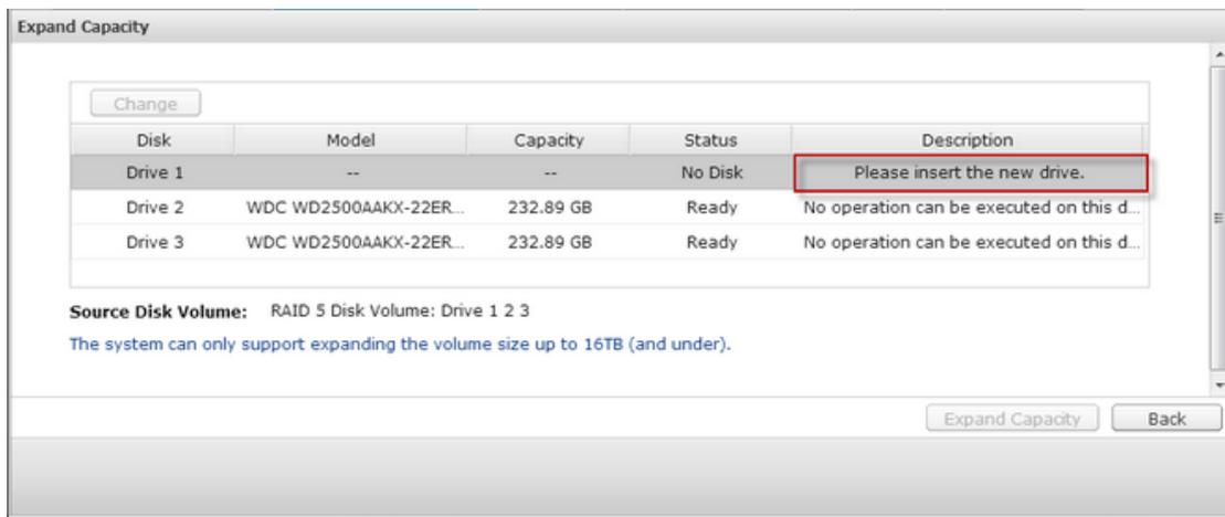
HDDを挿入したら、ブープ音が鳴り、再構築が開始されます。
