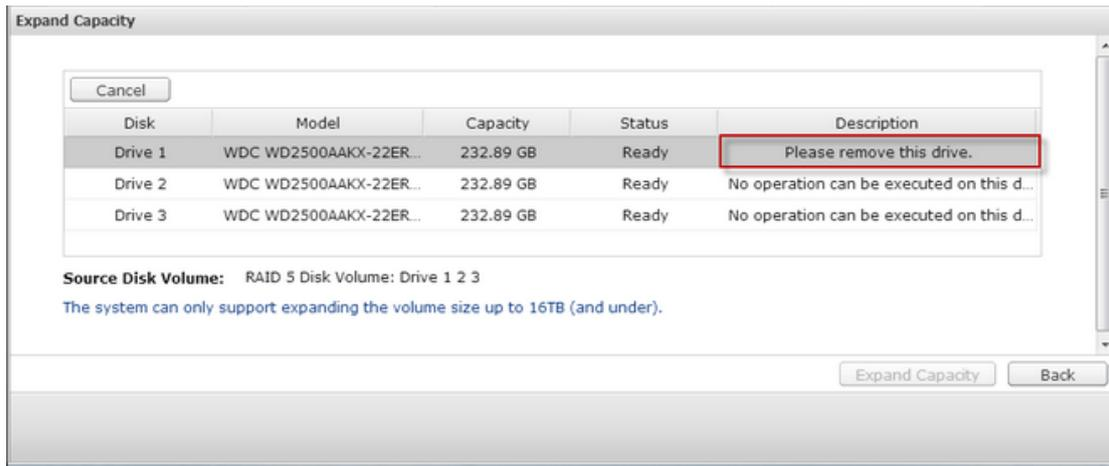
「新しいドライブを挿入してください」というダイアログが表示されたら、新しいHDDをHDDスロットに挿入してください。
