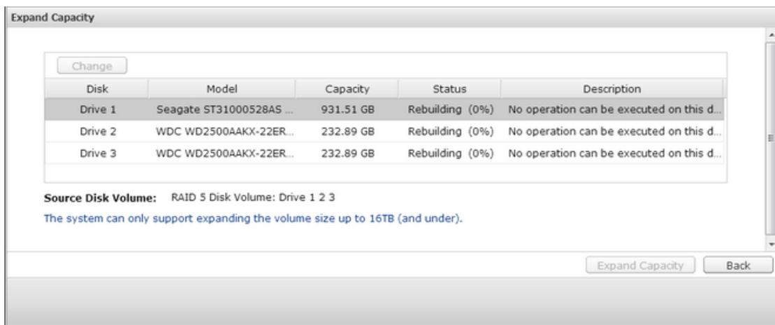
再構築が完了したら、上記の手順を繰り返して、1台ずつHDDを交換します。
