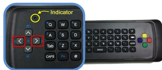
※接続が正常に行われるとインジケータが点滅し、リモコンが使用できるようになります。
