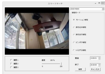
カメラを選択して、カメラの検知モード、開始時間、終了時間を入力し、「検索」ボタンを押してください。
