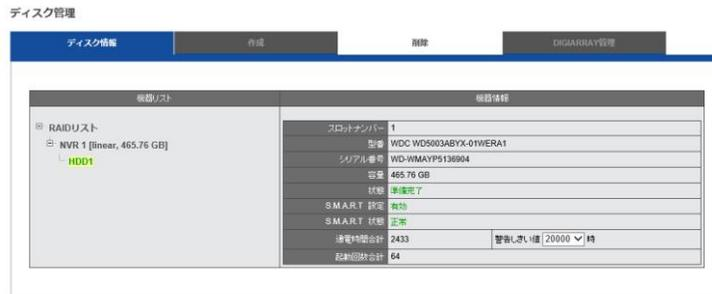
また、個々の HDD をクリックすることで、S.M.A.R.T.の状態を確認できます。また、HDD 稼働時間の設定を行うことで、メンテナンスの目安として使用できます。
