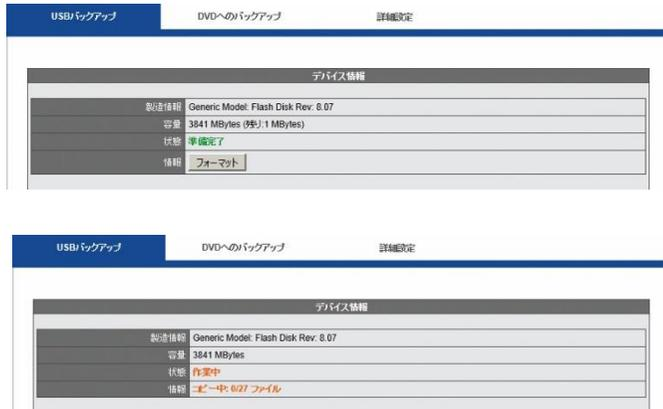
USB ストレージが「準備完了」になると、USB インジケータは青色で点灯します。バックアップを開始すると、状態が「作業中」となり、情報にはコピー中のファイル数が表示されます。
