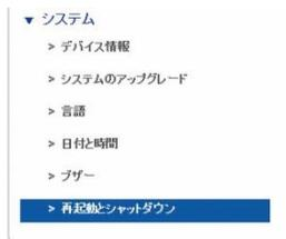
※電源を落とす場合は、必ず「シャットダウン」を選択するか、もしくは前面ボタンを長押し（1.5秒程度押しと1度ピーブ音が鳴ります。ピーブ音が鳴った後、電源ボタンから指を離してください）し、電源を切ってください。
