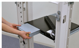
◀ラック設置—バッテリー交換
