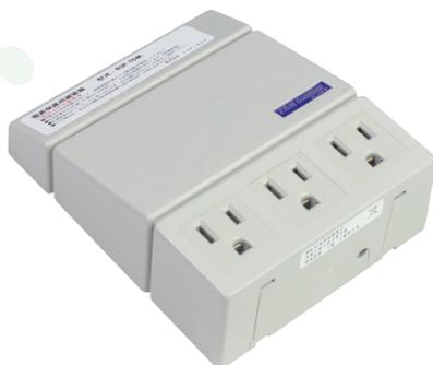
電源保護用 SPD は、誘導雷に多いと言われる 10,000A の過電流を 1,000 回処理可能な高い性能を有しています。過電圧に対しても強力な抑制値を誇ります。本体底部に、オプションの通信保護モジュールを連結することで、電源・各種通信・アースから保護対象機器へのサージの侵入を防ぎます。
